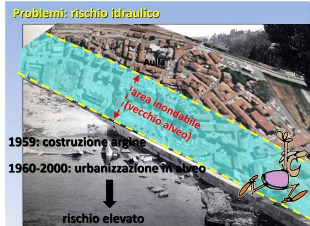
Due slides di una presentazione che illustra gli effetti del consumo di suolo e del restringimento dell'alveo e della riduzione delle aree di esondazione del fiume (fonte Pino Sansoni)
